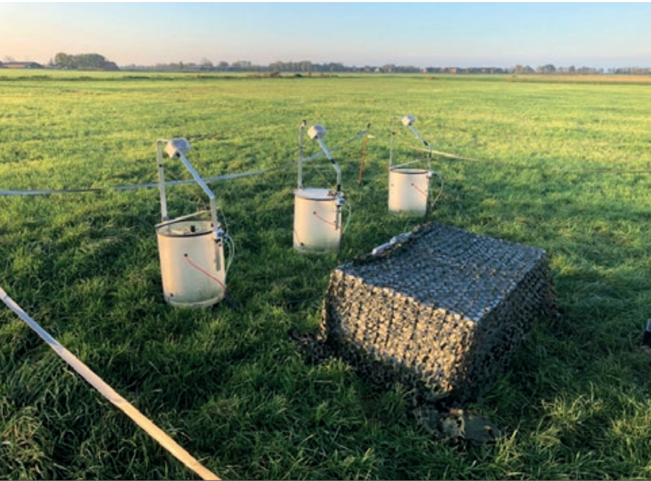
Figuur 3.1 Een mobiele meetopstelling met drie closed chambers. Dit is één van de meetmethodes die wordt gebruikt om de CO2-uitstoot van de Friese Veenweide te meten.
