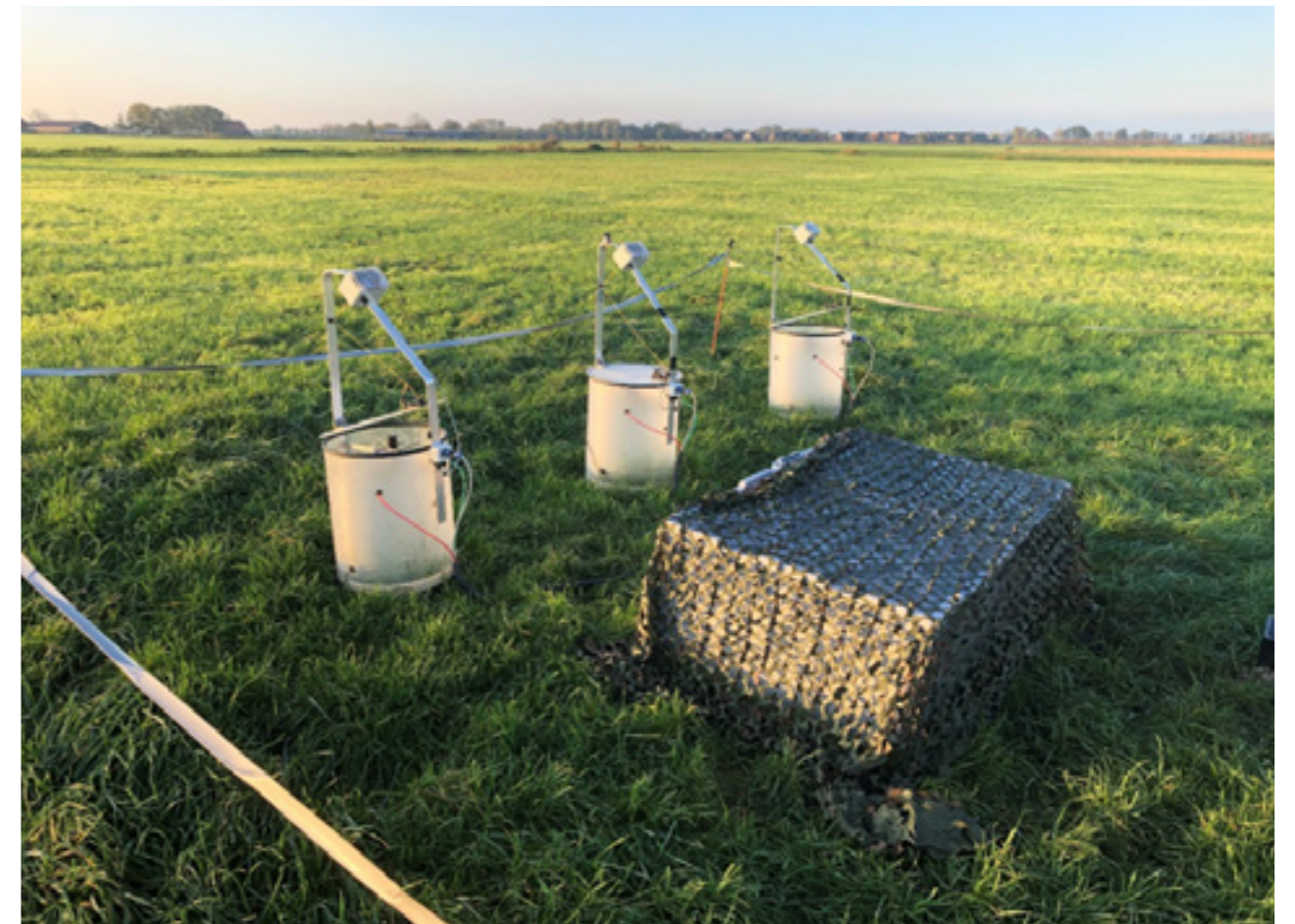
Figuur 3.1 Een mobiele meetopstelling met drie closed chambers. Dit is één van de meetmethodes die wordt gebruikt om de CO 2 -uitstoot van de Friese Veenweide te meten.
