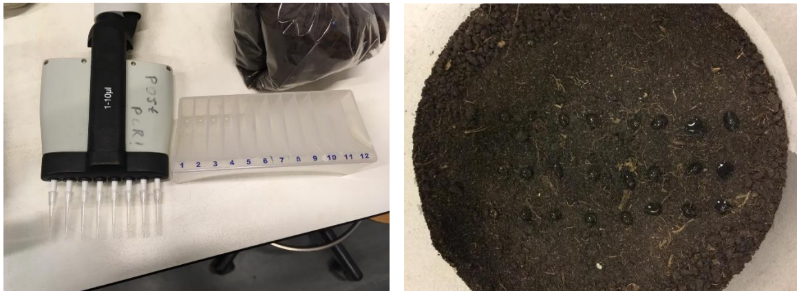
Figuur 2 a) Multipipet waarmee 8 druppels van 10µL met oplopend % ethanol tegelijk kunnen worden gedruppeld. b) het aantal druppels dat na 10 seconden nog zichtbaar is bepaalt de mate van hydrofobie van een bodemonmonster (bij dat bodemvochtgehalte).
