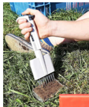
Met een rechthoekig frame wordt uit het bodemprofiel genomen, waar direct de druppeltest op wordt uitgevoerd.
