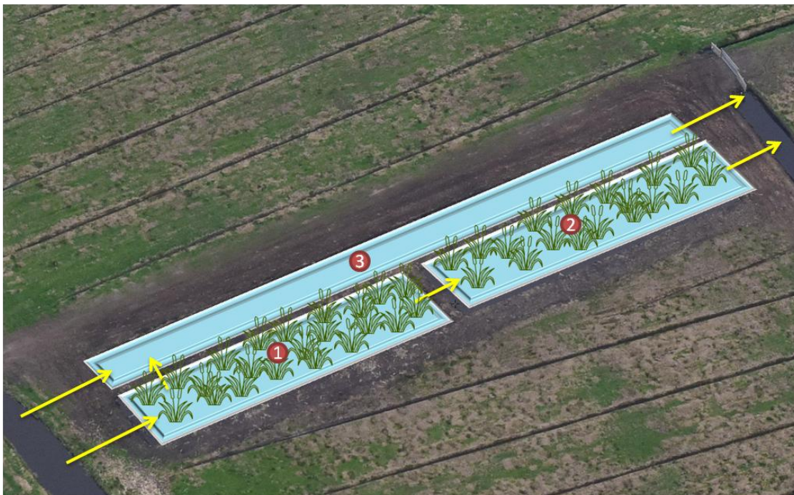
Figuur 4.1. De inrichtingsopzet voor de lisdoddeteeltbedden bij natuurboer van der Ploeg. De teeltbedden 1 en 2 zijn in 2017 ingericht, en in de zomer van 2019 is het derde teeltbed ingericht. De gele pijlen geven aan waar de verbindingen zijn met de hooggelegen aanvoersloot (linksonder), onderling tussen de teeltbedden, en met de afvoersloot (rechtsboven). De nummers van de teeltbedden komen overeen met de beschrijvingen in de rest van deze paragraaf.
